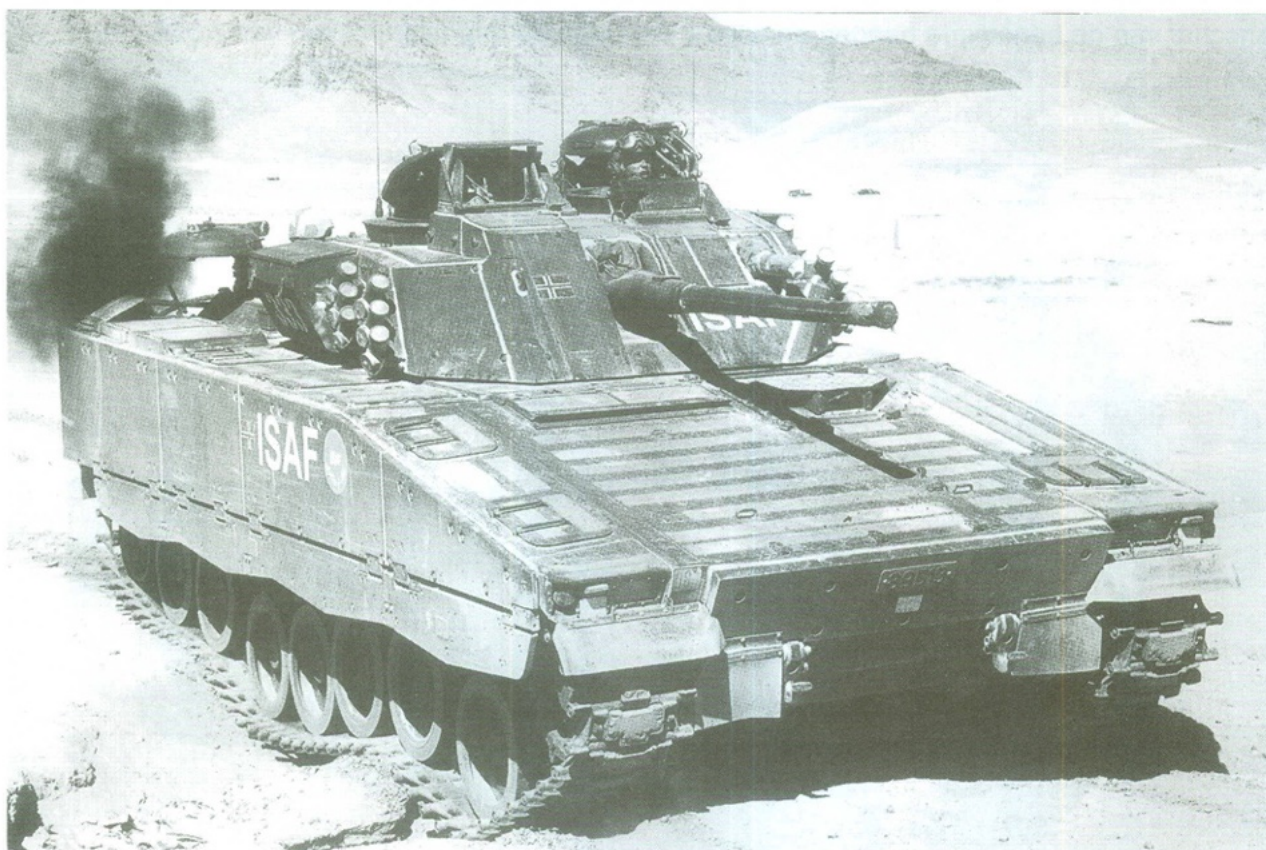
Een Noorse CV9030N in Afghanistan. De ronde cupola voor de groepscommandant is duidelijk zichtbaar. (Foto Yves Debay, RAIDS)
